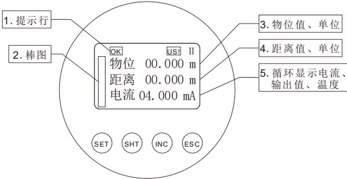
图25 超声波物位计主界面（(4~20)mA输出）
