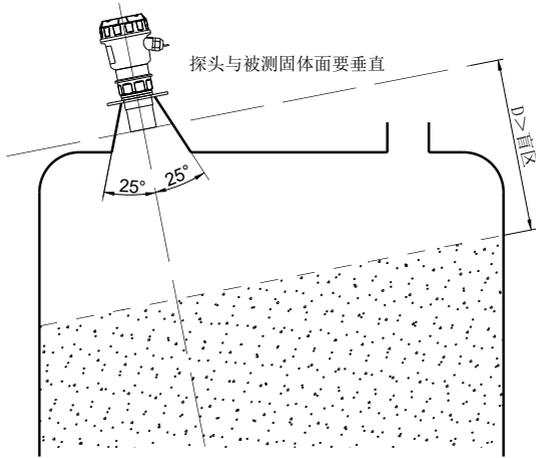
图18 测量固体介质的延长接管
