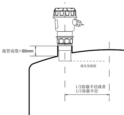
图7 安装在螺纹接管上--拱形罐顶
