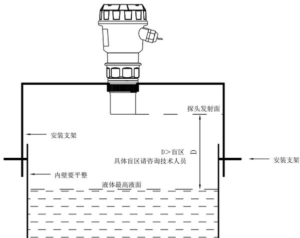
图10 安装在开口容器上--顶部居中支架
