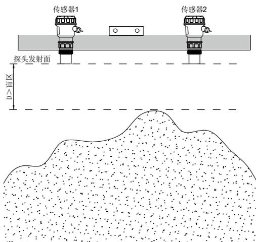
图15 安装在露天料堆--起重架上
