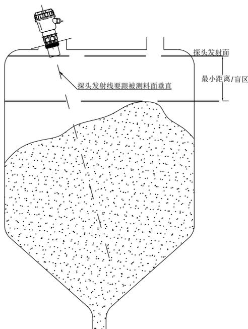
图12 安装在容器法兰上
