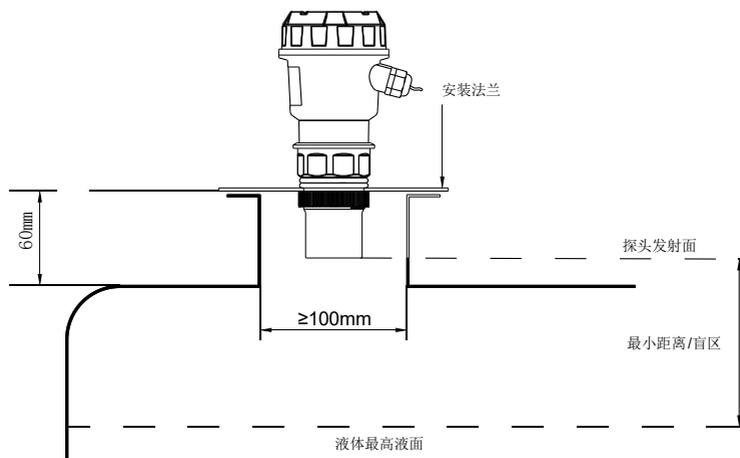
图3 法兰安装--安装在很短的接管内
