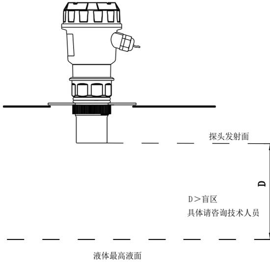
图5 法兰型安装在无接管平项罐上
