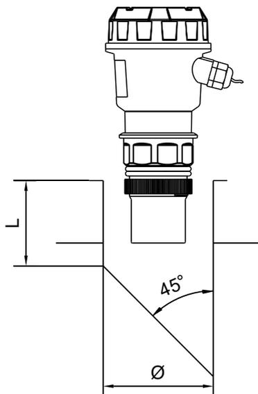
图17 不浸泡在介质中的延长接管
