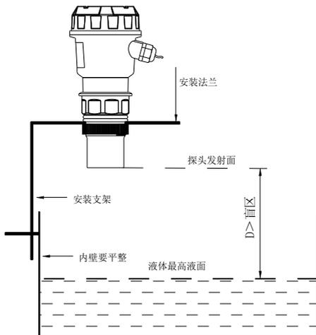
图9 安装在开口容器上--顶部靠一侧支架
