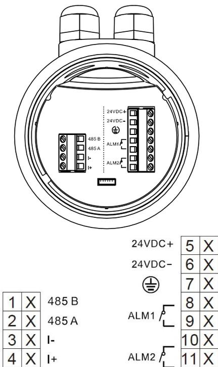
图24 3/4线制超声波物位计接线图
