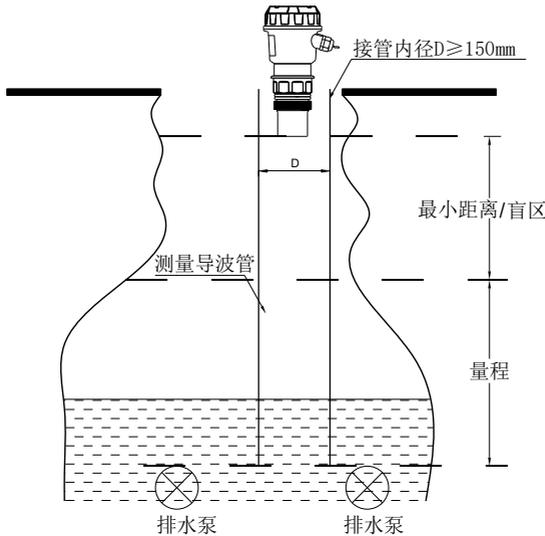
图11 安装在排水井—接管和测量套管
