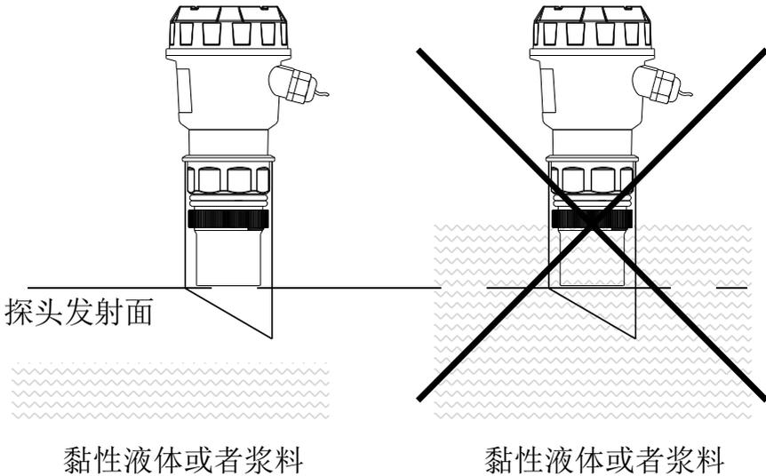
图16 接管不能浸泡在粘附性介质里
