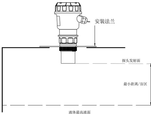
图4 法兰型（锁紧法兰）--安装在平顶罐上
