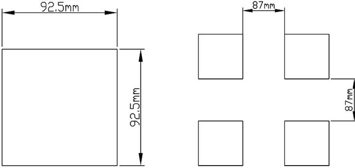
图 1 开孔尺寸及配电箱方孔间最小距离
